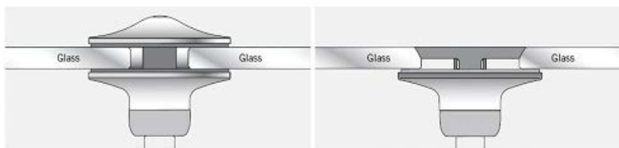
rátaakaró - a pontmegfogó szerelvény az üvegsíkra rátaakar, színelő - a pontmegfogó szerelvény az üvegsíkba süllyesztett, azzal színel.
