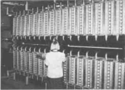
Bild 12 Fotografische Aufnahme des Schimmelpilz-Prüfstandes des Fraunhofer-Instituts für Bauphysik.
